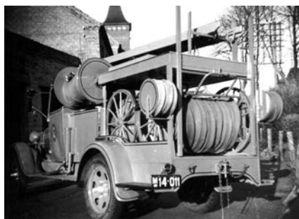
Sprøjte – Ford 31 – M14.011 Muligvis Vogn 20. Udskiftet Oktober 1948. Vandtank på 200 liter. Bemærk rør til frontpumpe.
