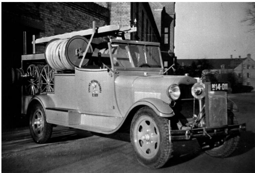
Sprøjte – Ford 31 – M14.011 Muligvis Vogn 20. Udskiftet Oktober 1948. Vandtank på 200 liter. Bemærk rør til frontpumpe.
