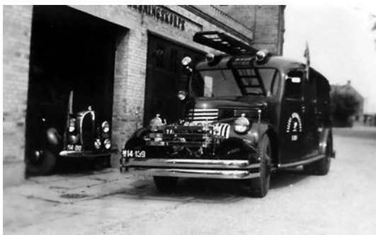
Ny brandbil 1948. Chevrolet, M 14.139, Vogn 88. Vandtank 800 liter. Sideskabe til stråle- rør, værktøj, presenning- er osv. Skab i bagende til 2 stk. slangevogne. Frontpumpe Aster med 2 B-afgang og 1 D- afgang.
